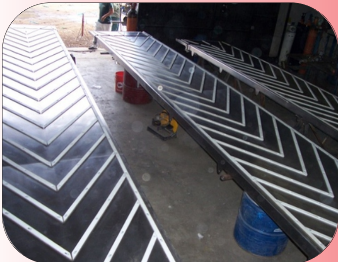
Cuerpo de transportador con guías laylami para caramelo
