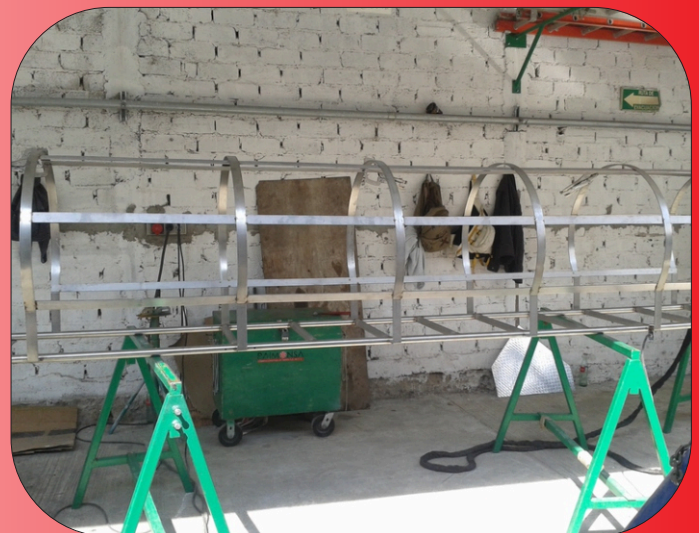
Escalera marina con guarda inoxidable
