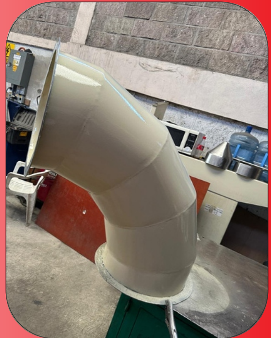
Codo de 50 cms de diametro por 90 armado en gajos hibridado
